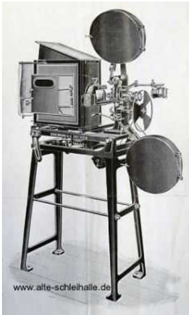
Ein kinematographischer Projektor von 1911. Typ Ernemann Stahl Projektor Imperator - stärkstes kettenloses Modell !
